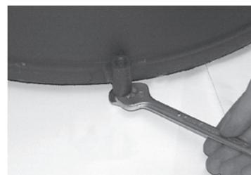
In die vorgesehenen Muffen (4) die Tauchhülsen (nicht im Lieferumfang enthalten) mit den darin befestigten Temperaturfühlern einschrauben.
