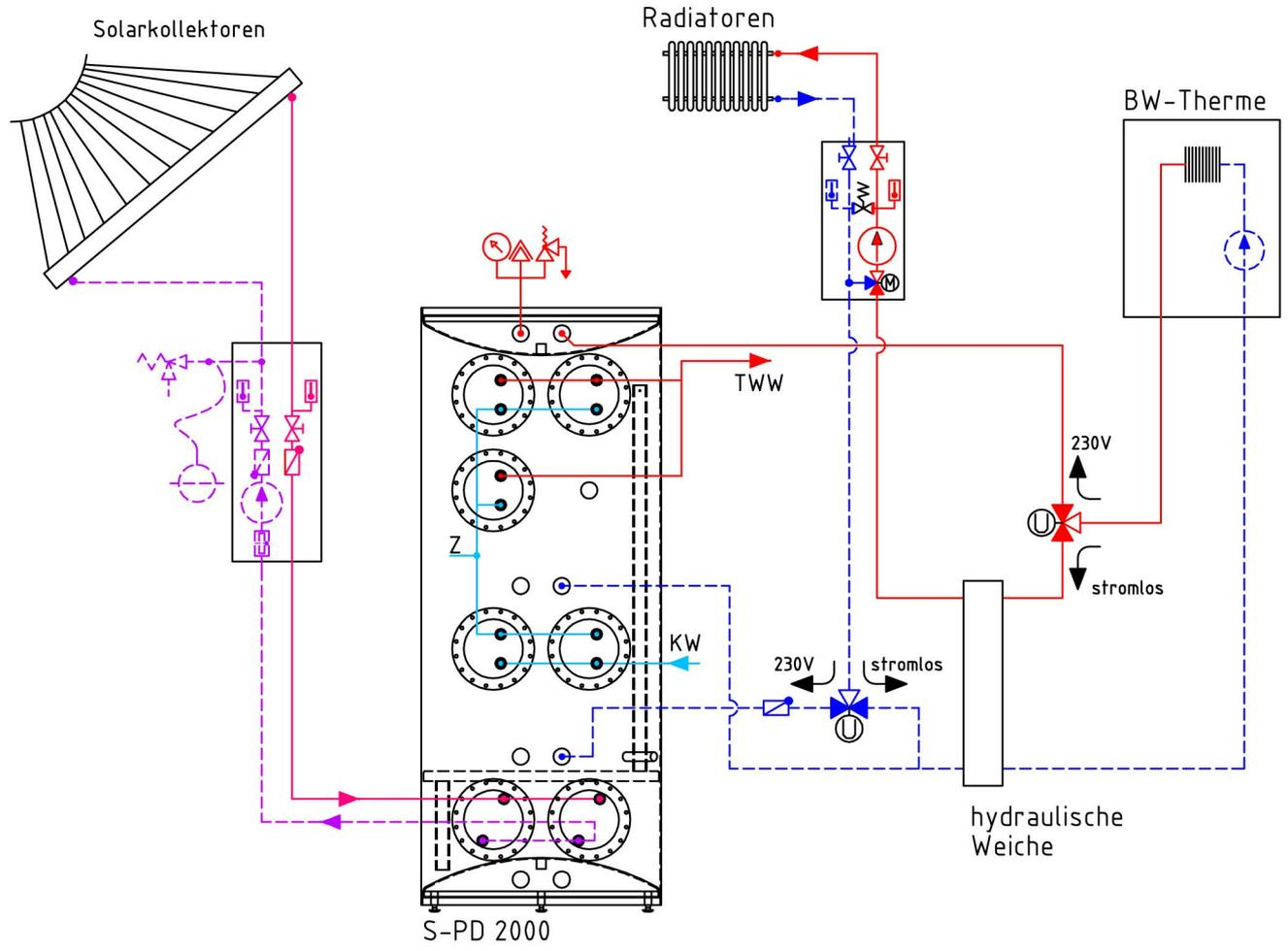
SF=Speicherfühler F4=Pufferfühler F2=Rücklauffühler F3=Kollektorvorlauffühler F1=Kollektorspeicherfühler
