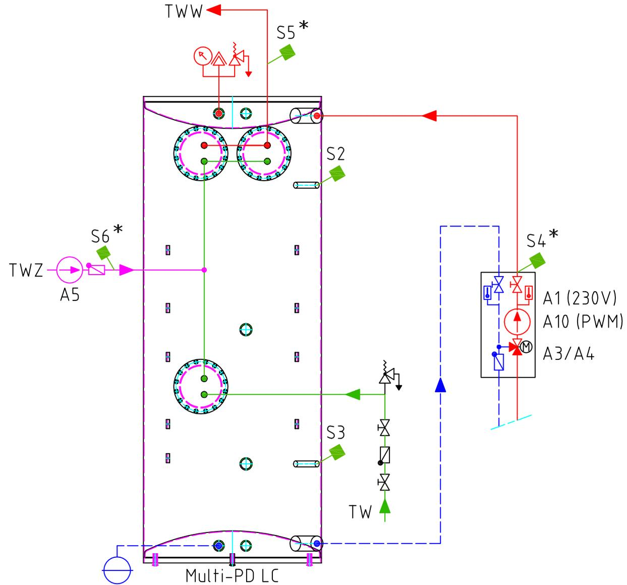
\*Einbau nur mit Einschraubtemperaturfühlern!
