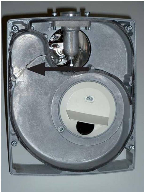
**Abb. 3:** ... dass der Abstand zur Gehäusewand 3 mm beträgt. Als Abstandsmaß eignet sich ein 3 mm Imbusschlüssel.
