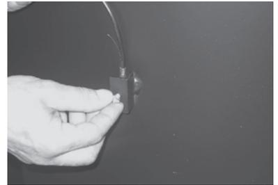
6. Entsprechend den Speicher-Anschlüssen und dem Lochbild der Stutzen die Seitenteile (a) deckungsgleich am Speicherkörper anlegen.
