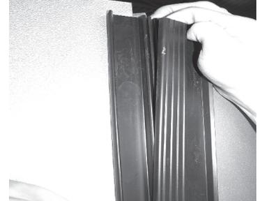
9. Deckeldämmung (b) oben einlegen.
