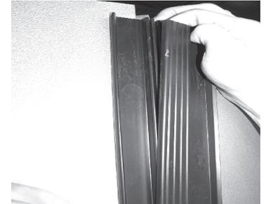
9. Deckeldämmung (b) oben einlegen.
