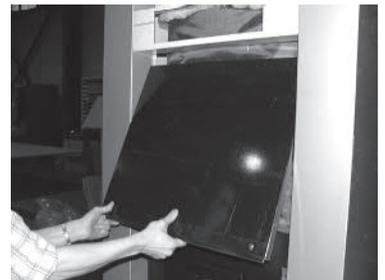
Halsstützen-Isolierplatten hinter die Rückwand schieben. Den Kantenschutz auf die Halsstützen-Ausschnitte der Rückwand einstecken.
