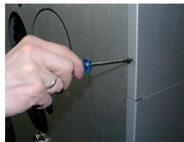
Kantenschutz für Kabeldurchführung hinten einstecken.
