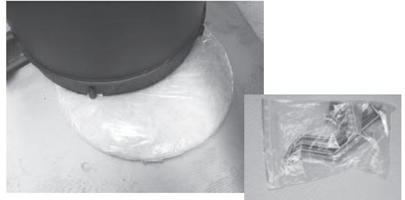
Die im Kunststoffbeutel liegenden 4 Isolierhalterungen (Flacheisen mit eingedrehter Schraube sowie Bohrung am Ende) von oben mit der Bohrung über das Gewinde der Flachrundschraube stecken.
